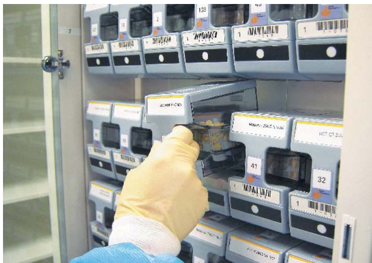
BEFÜLLEN EINES BLISTERAUTOMATEN Vorratsbehältnisse, aus denen die Maschine die Arzneimittel für die Verblisterung abrufft.
