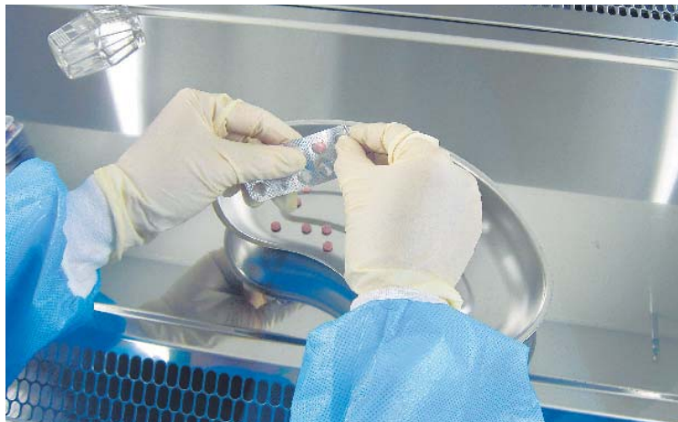
ENTBLISTERT Der erste Schritt zur Neuverblisterung ist die Entblisterung der Ware – sie findet unter Reinraumbedingungen statt.
